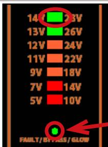
電圧インジケータ最上部のランプが点滅から点灯に変わり、
