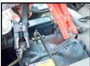
⊕、⊖クランプを外して作業完了。
