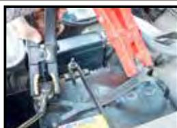
⊕、⊖クランプを外して作業完了。
