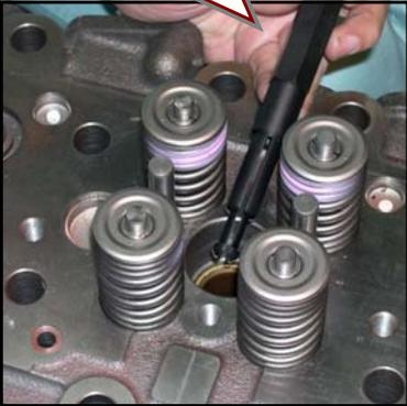
押しボルトをネジ込み、チャック先端部を拡張し、巻き上げナットでノズルチューブを抜き取ります。
