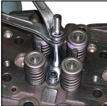
フランジでノズルチューブを装着します。
