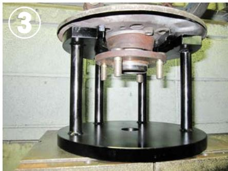
③ 作業車両のナックル ASSY を工具の上に置き安定しているか確認してください。
