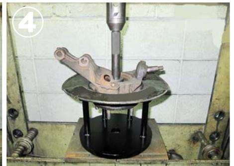
④ 工具の上に作業車両のナックル ASSY が安定している状態でハブの抜き取りを行ってください。
