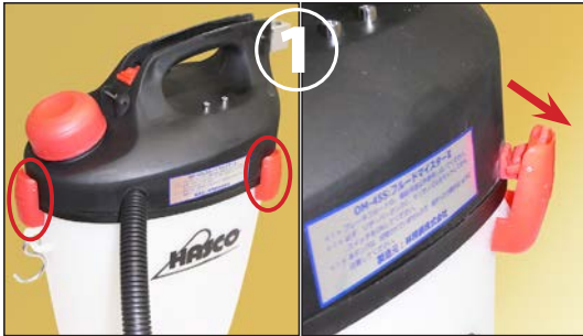
① 本体タンク3カ所に有る、タンク固定フックを外側に起こして取り外してください。
