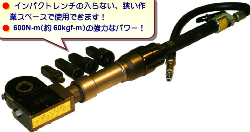
ロスの多い、ギアやチェーンで駆動方向を変換している、インパクトレンチ方式と異なり、エアハンマーによる強力なショックをロスなく伝え、ハイパワー車のクランクプリーボルトでも簡単にゆるめられます。メガレンチを掛け、ハンマーで叩くことはありませんか？この原理です。これにより、ラジエーターなどもそのままですき間に入る(一部車種を除く)、スリムボディが実現しました!!
