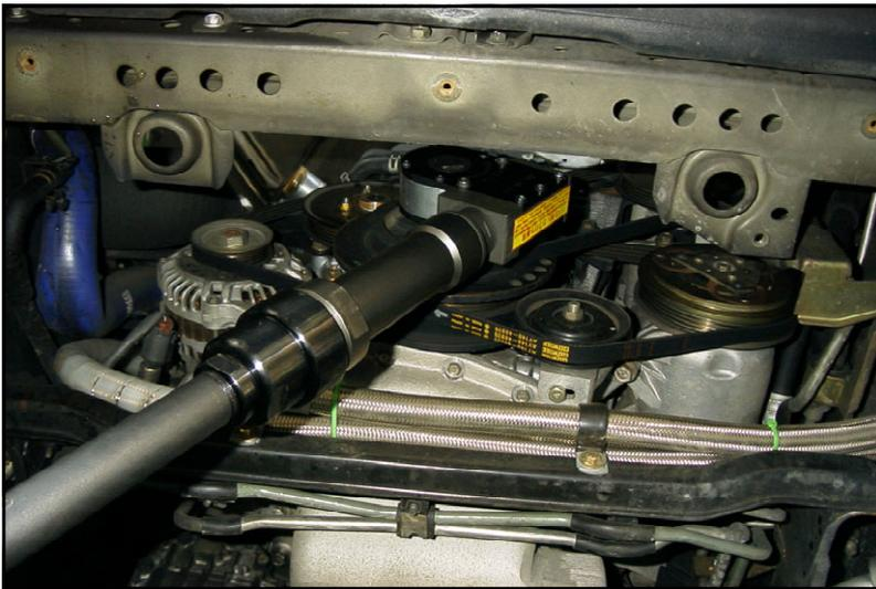
カラ打ちは厳禁です。本ツールのドライブは自転しますが、インパクトレンチのような早回し回転工具とは異なります。ハンドラチェットレンチと考えてください。したがって、基本的にはプリーの供回り防止対策が必要ですが、Vバンドハンドルなどの簡易的なもので十分です。作業時は、常に回転方向に本ツールを引き、負荷を掛けた状態で作動させてください。少しゆるんだら、作動を停止して手動でボルトを外してください。
