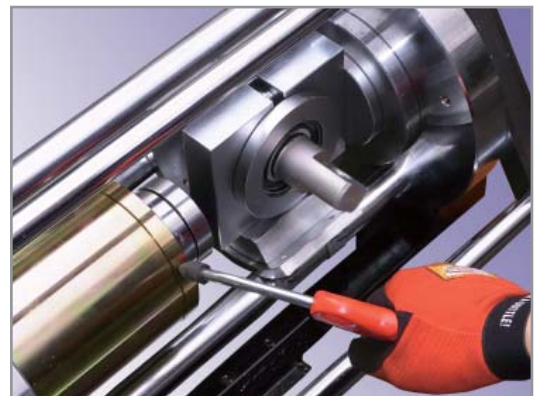
5, いったん油圧を抜き、エアガンでピストンを戻し、ブッシュコンプレッサーから圧縮されたブッシュを取り出します。
