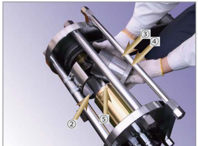
8, 新しいブッシュをセットし、抜き取り時と同様に受け金②をのせ、装着用アタッチメント③(短い方、向きに注意)、当て金A④、当て金⑤の順にセットします。油圧ポンプを作動させて、基準の位置までブッシュを圧入します。
