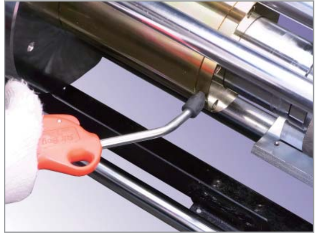
6, エアガンで、ピストン戻し用穴に圧縮エアを吹き込み、ピストンを戻します。この時ポンプ側は、開放状態にしておいてください。
