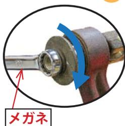
②メガネ (22H) でナットを締め込み、アッパーリンクとフルクラムピンの間をあける。
