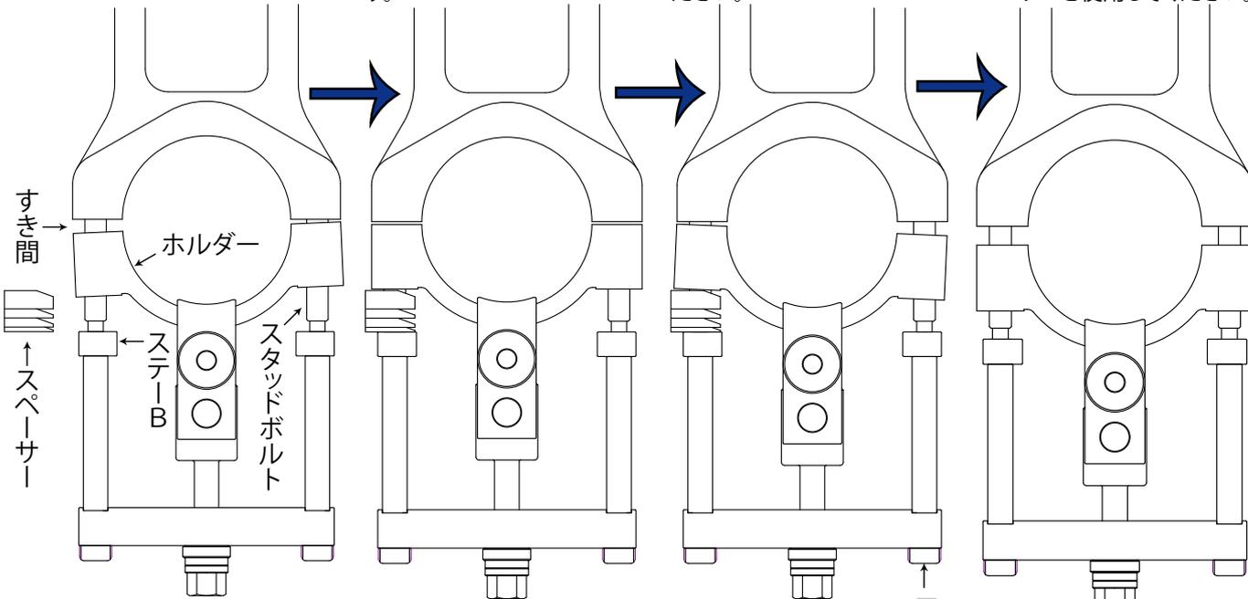
※-12・ハンガーボルトは消耗品です。ハンマー打撃で亀裂が入ったり、著しく変形した時は、補修部品と交換してください。
