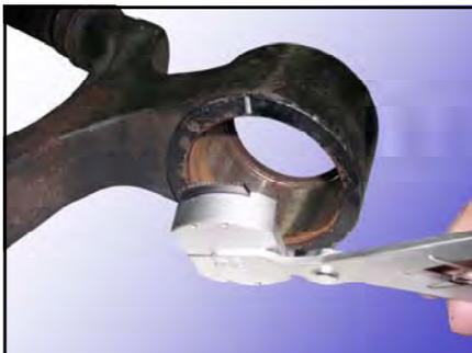
リング溝内に、サビや汚れが付着していると、基準位置までスナッピングが拡がらず、作業は振り出しです！
