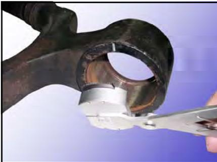
リング溝内に、サビや汚れが付着していると、基準位置までスナップリングが拡がらず、作業は振り出しです！
