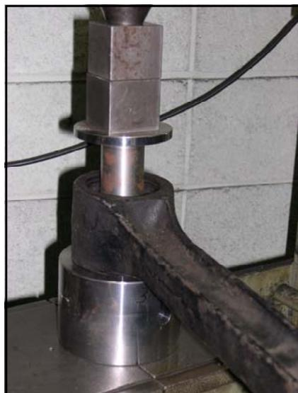
受け台と、当て金を使用して、古いブッシュを抜き取ります。6トン程度の圧力で抜けます。
