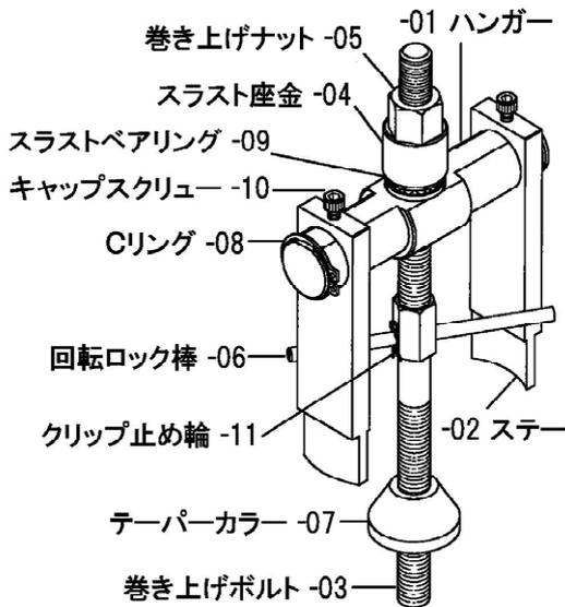
ハブ（ホイール）ベアリングの、アウターレース脱着およびハブ挿入用ツール。プレス、スライドハンマーを使用しないネジ式プーラー
