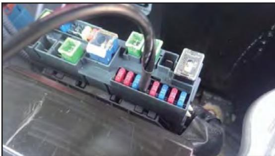
切断されているヒューズを取り外し、発信器のコネクタを差し込みます。
