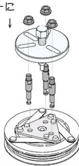
丸穴3ヶ所に爪を差し込み、ハンガーを右に軽く回して、先端部をクラッチに掛けます。
