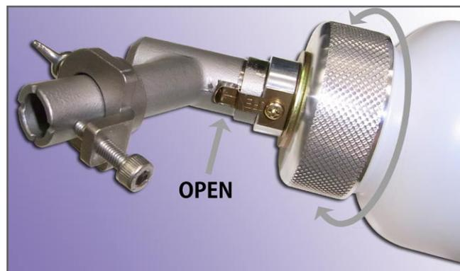
フルードタンクをひねり、「OPEN」に合わせれば、フルードが自動供給されます。反対に180度ひねれば、弁は閉じフルードは止まります。
