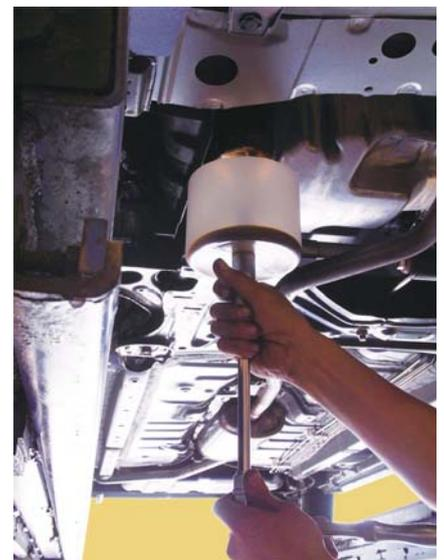
オイルフィルターをゆるめると廃油が出てきます。タイミングを見て工具を引き抜いてください。
