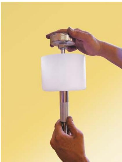
車両のオイルフィルターのサイズに合った工具をセットします。
