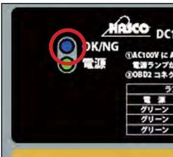
**ブルー**ランプ点灯によりバックアップが開始される。
