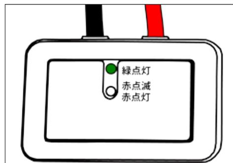
③ 溶接作業時に、溶接ノイズの吸収を検知した場合
