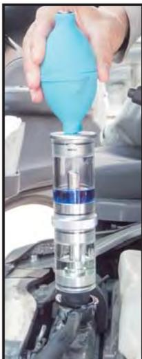
ラジエターキャップ部分に取り付けて、車輛のサーモスタットが開くまで冷却水を循環させる。
