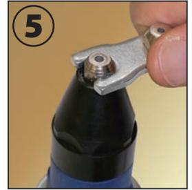
⑤付属ハンドルで工具を押さえ、付属スパナでチップを締め付けます。
