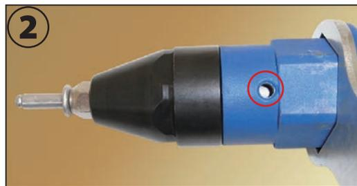
② リベットをセットする際には本体左右に有る上記画像の○の箇所がシルバーになっている事を確認してからリベットを先端にセットしてください。
