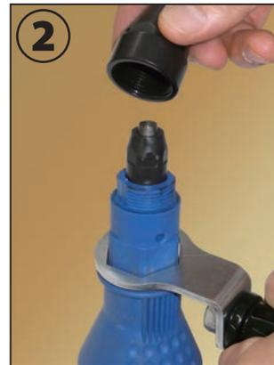
②手で先端キャップを取り外します。
