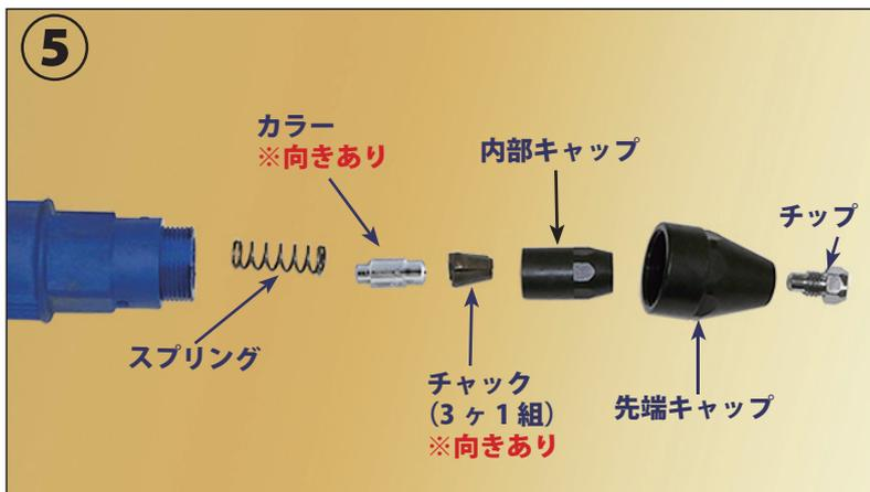
⑤先端キャップ・内部キャップの汚れを清掃し、内部キャップの内側・カラー・スプリングにグリスアップを行ってください。
