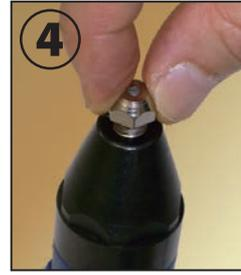
④付属スパナに付いているチップを手で外し工具に取り付けます。また取り外したチップは付属スパナに取り付けます。
