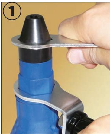
①付属ハンドルで工具体を抑えて、先端キャップを付属メガネレンチでゆるめてください。【正ネジです】
