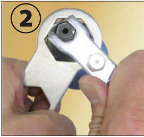
②付属メガネレンチで先端キャップを押さえ、付属スパナでチップをゆるめます。【正ネジです】
