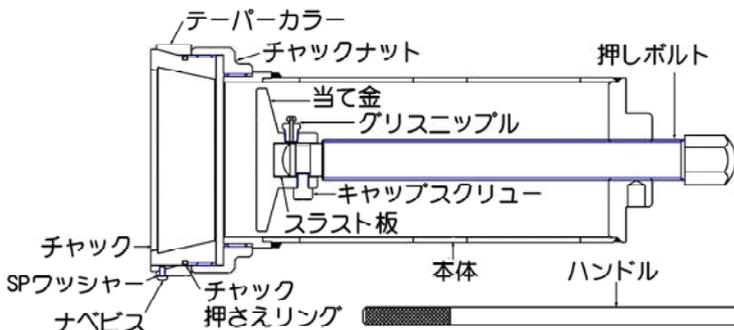
チャック（3ツ割れ）が、リングから外れてしまった場合は、上端面にある、合わせマーク（一線）の位置を合わせて組み直してください。
