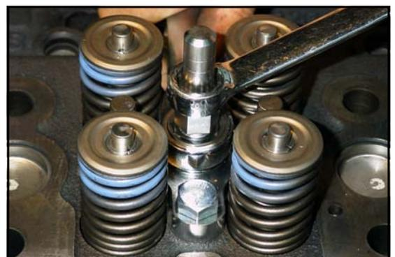
(3)ポンチをレンチで押さえながら、巻き上げナットM15を締め込み、ポンチAを抜き取ります。ポンチB(目印ミゾ2本)を、上記同様に作業を行えばカシメ完了です。
