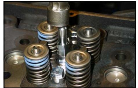
(2)ポンチA(目印ミゾ1本)に、巻き上げナットM15をいっぱいまでネジ込んでおき、座金M15を通します。ポンチのカシメ部周囲に薄くオイルを塗り、ポンチガイド内に挿入します。巻き上げナットを入れ忘れると、ピストンを損傷したり、ポンチが抜き取れなくなりますのでご注意ください。
