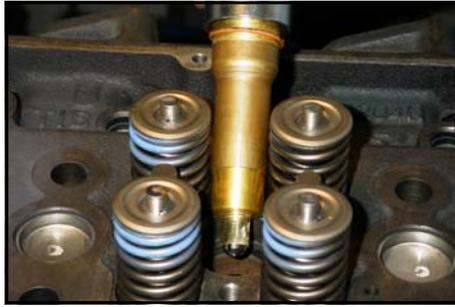
(3)ガイドカラー M のサイド穴に、ドライバーなどを差して供回りを防止するか、押しボルト頭部をレンチでしっかり保持しながら、巻き上げナット M12 をレンチで締め込むと、ノズルチューブが抜き取れます。
