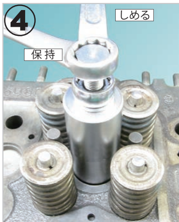
④押しボルト頭部をレンチでしっかり保持しながら、巻き上げナット M12 をレンチで締め込みます。
