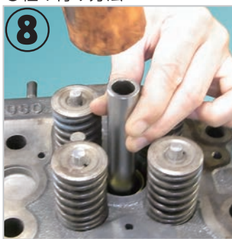
⑧新しいノズルチューブとOリングを組み込みます。ポンチガイドを当て金にして、プラスチックハンマーで定位置まで打ち込みます。
