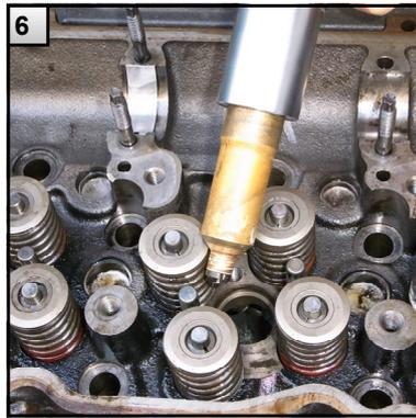
(5)押しボルト頭部をレンチでしっかり保持しながら、巻き上げナット M12をレンチで締め込みます。
