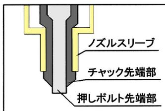
(4)チャックの六角とガイドカラー内部の六角位置を合わせながらかぶせます。ガイドカラーのサイド穴に、ドライバーなどを差して供回りを防止しながら、押しボルトを締め込みます。最後まで完全に締め付けてください。
