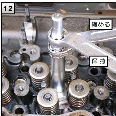
(12)ポンチをレンチで押さえながら、巻き上げナット M15を締め込み、ポンチAを抜き取ります。ポンチB(目印ミゾ2本)を、上記同様に作業を行えばカシメ完了です。
