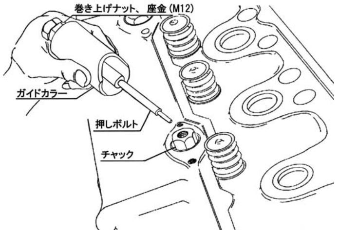
押しボルトに、巻き上げナットをいっぱいまでネジ込んでおき、座金およびガイドカラー-B (内部が六角)に通します。
