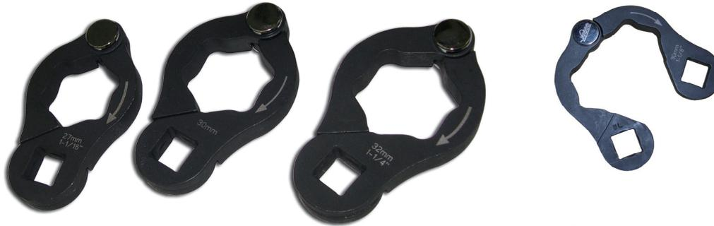
左写真のようにバタフライレンチを開き、ナットまたはボルトを包み込むように閉じて、1/2"(12.7sq)ドライブのラチェットレンチやスピナーハンドルを差し込んで使用してください。
