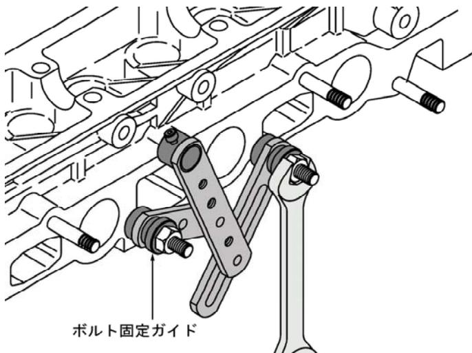
3. 位置決め固定済みのプレート本体組みを、反転させてシリンダーヘッド側に合わせます。
