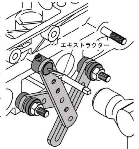
6, 適合するサイズのエキストラクターを、ドリル穴に打ち込み、ダイスハンドルなどで折れたスタッドを抜き取ってください。
