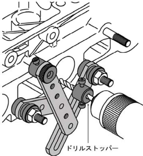
5, 他のスタッドを外し、ドリル穴の深さを計測して、ドリルストッパー (DG-1286FS のみセット入り) を取り付けるか、目印線を入れてください。
