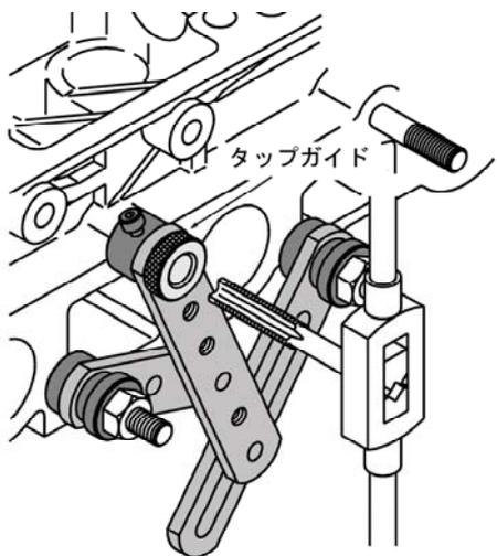
7, ヘリサートを組み込む時は、上記4~6, の手順で、ヘリサート用タップの下穴加工後、タップガイド (DG-1286FS のみセット入り) に差し替えて雌ネジ加工を行い、専用ツールでヘリサートを組み込んでください。
