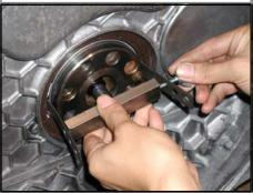
4. センターボルトのストロークを考慮し て、先端にキャップBまたはCを取り付 けます。2つのシール抜きフックを、蝶 ボルトでシール抜き本体に取り付けま
