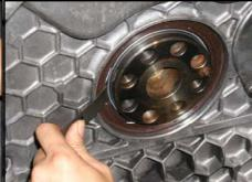
2,シール抜きフック先端を、スリンガー とシールの間に押し込みます。
