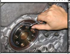
1, オイルシール内径側のフェルトを、細 いドライバーなどで剥がしてください。 <!>ケース内面およびクランクシャフトに 傷を付けないよう注意してください。
