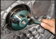
11, レンチで軽く均等に締め付けます。 <!>片方を強く締めると、平行が出なく なりますので、はじめに指で軽く均等 に締めてください。
