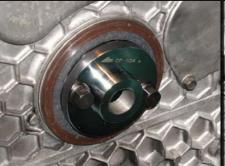
ます。オイルシール用アタッチメントに、 エンドキャップおよびセンターボルト (スペーサー)をセットして、ベース プレートに取り付けます。
