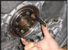
3, シール抜きフック先端が、シールの内 側に引っかかるように起こします。同 様に対面側にも爪を取り付けます。
