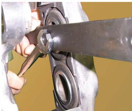
チャックの拡張しすぎは厳禁です。固くてピストンが動かない時は、一度チャック部をゆるめ、再度ゆるめに締めて試してください。これで簡単に抜ける場合もあります。チャックが破損した場合は、保証対象外の有償修理となりますのでご注意ください。
