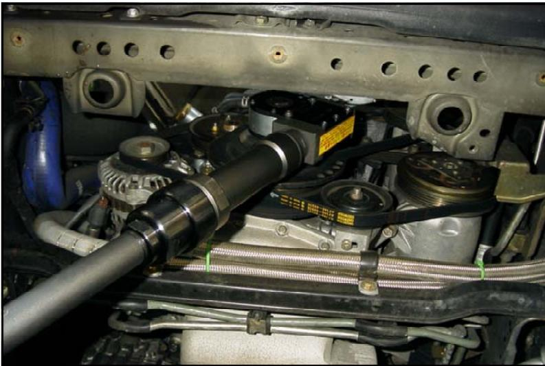
カラ打ちは厳禁です。本ツールのドライブは自転しますが、インパクトレンチのような早回し回転工具とは異なります。ハンドラチェットレンチと考えてください。したがって、基本的にはプーリーの供回り防止対策が必要ですが、Vバンドハンドルなどの簡易的なもので十分です。作業時は、常に回転方向に本ツールを引き、負荷をかけた状態で作動させてください。少しゆるんだら、作動を停止して手動でボルトを外してください。
